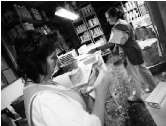
Antes de esmaltar cada pieza hay que proceder a su limpieza. Proceso de esmaltado manual de azulejos y de piezas mediante el sistema tradicional debaño o inmersión. Los esmaltes y barnices cerámicos se diluyen en agua hasta alcanzar la densidad de trabajo deseada
