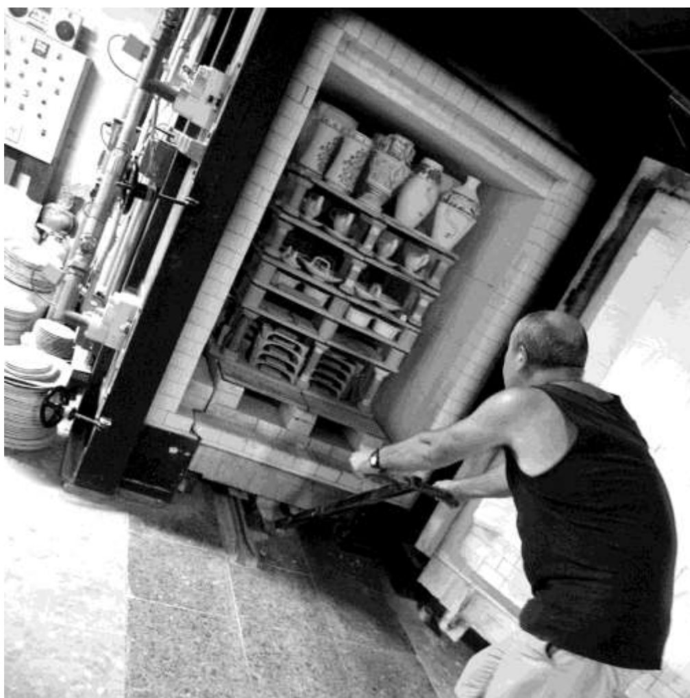
Introduciendo la vagoneta cargada de piezas en el horno para proceder a la cocción.
