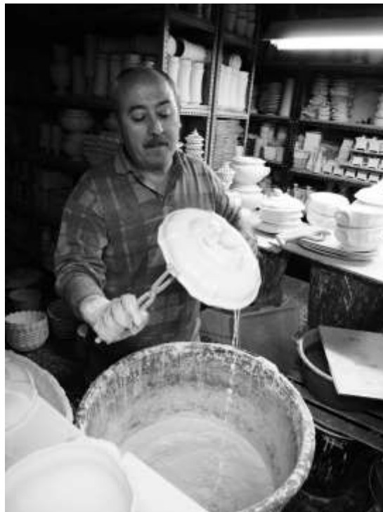
Antes de esmaltar cada pieza hay que proceder a su limpieza. Proceso de esmaltado manual de azulejos y de piezas mediante el sistema tradicional debaño o inmersión. Los esmaltes y barnices cerámicos se diluyen en agua hasta alcanzar la densidad de trabajo deseada
