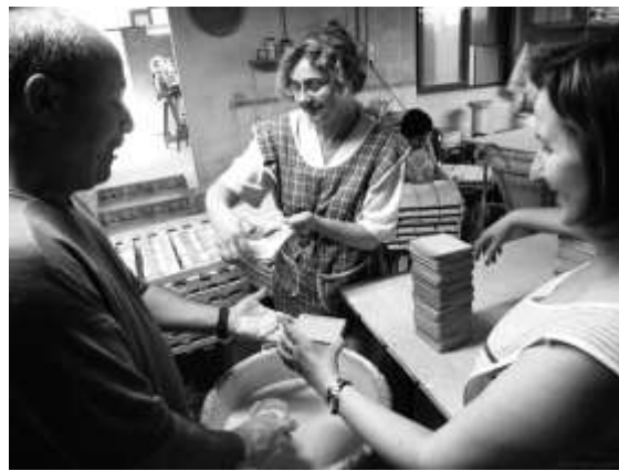
Antes de esmaltar cada pieza hay que proceder a su limpieza. Proceso de esmaltado manual de azulejos y de piezas mediante el sistema tradicional debaño o inmersión. Los esmaltes y barnices cerámicos se diluyen en agua hasta alcanzar la densidad de trabajo deseada
