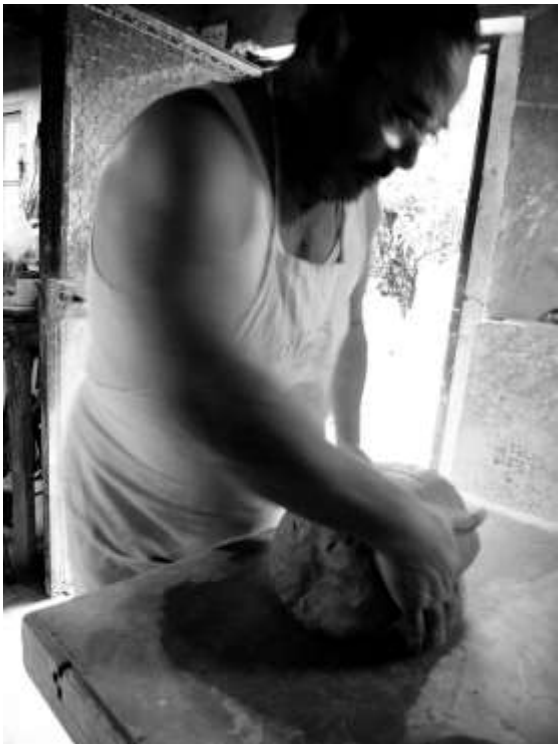
La arcilla se amasa para su homogenización antes de elaborar cualquier pieza.
